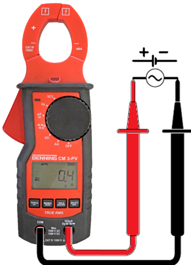
Afbeelding 11: Stroomsterktemeting m.b.v. de veiligheidsmeetkabels ( \mu\text{A} )
