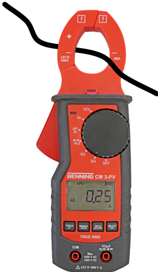
Afbeelding 10: Meting van de stroomsterkte m.b.v. de ampèretang (A)
