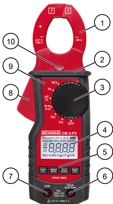
Afbeelding 6: Opbouw van het apparaat BENNING CM 3-PV
